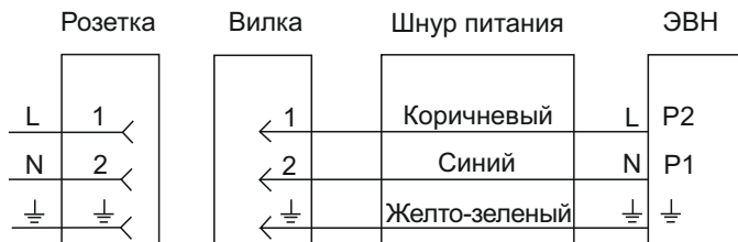
Рисунок 5 - Схема подключения ЭВН к однофазной электрической сети переменного тока частотой 50Гц напряжением 220В
