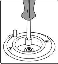
Замена инжекторов в горелках плоскости готовки производится следующим образом:
