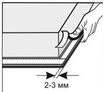
Плита укомплектована специальным уплотнением, пред-назначенным для предотвращения попадания жидкости внутрь мебели.
