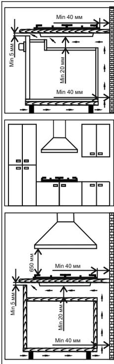
Плита предназначена для установки в мебель шириной не менее 600 мм.
