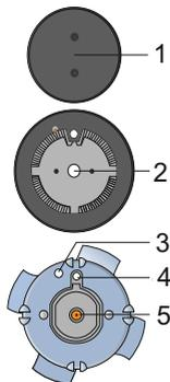
Горелки снабжены защитным устройством контроля пламени (УКП). Если пламя в горелке случайно погаснет (например, при проливании кипящей жидкости или при сильном сквозняке в помещении) подача газа автоматически прекращается во избежание его концентрации в помещении.
